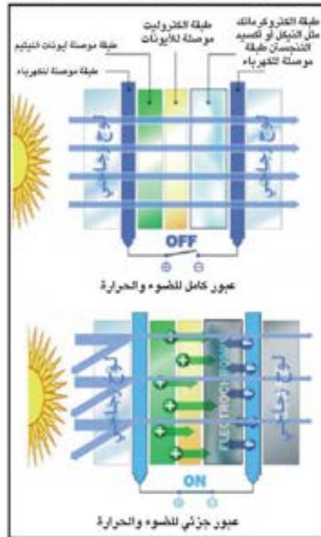
● شكل (٤) رسم تخطيطي لنموذج سطح شفاف جُهِز بتقنية تغيير اللون .
